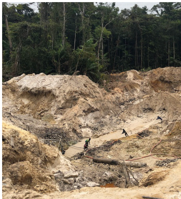
Abb. 6: Auswaschen und Hochpumpen des Sedimentschlammes (HANSMANN 2019)
